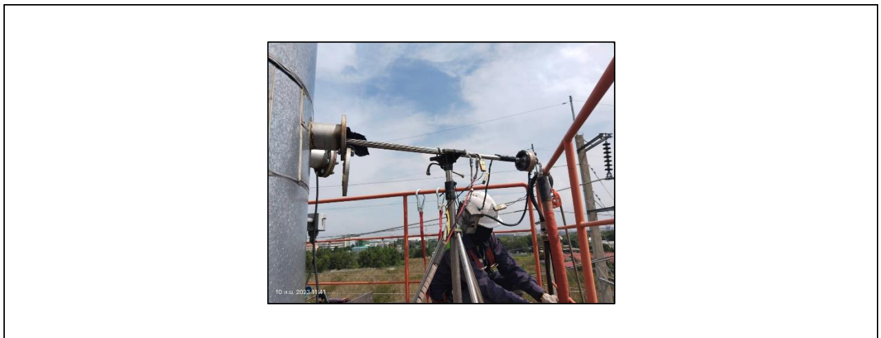
ภาพที่ 4.3.1-1 การตรวจวัดปริมาณของสารเจือปนในอากาศที่ระบายออกจากปล่อง
